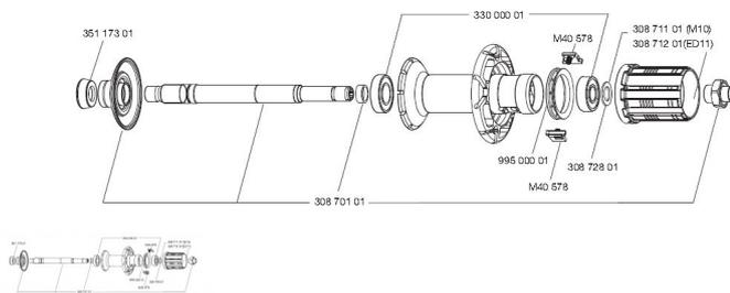
Corpetto RL FTS-L HG11 013 (compatibile perno 8 o 9mm)
